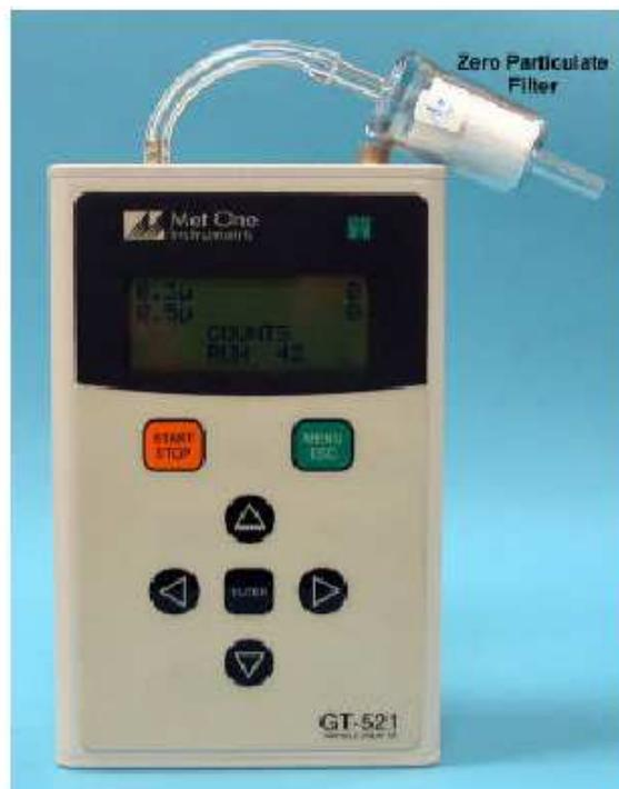
1. Stecken Sie einen 0,2µm Filter auf den GT-521 Lufteinlass. Der Filter muß groß genug sein um genügend Volumen für die Pumpe passieren zu lassen. Ein Nullfilter(Art.-Nr. G3111) ist im Lieferumfang enthalten.
