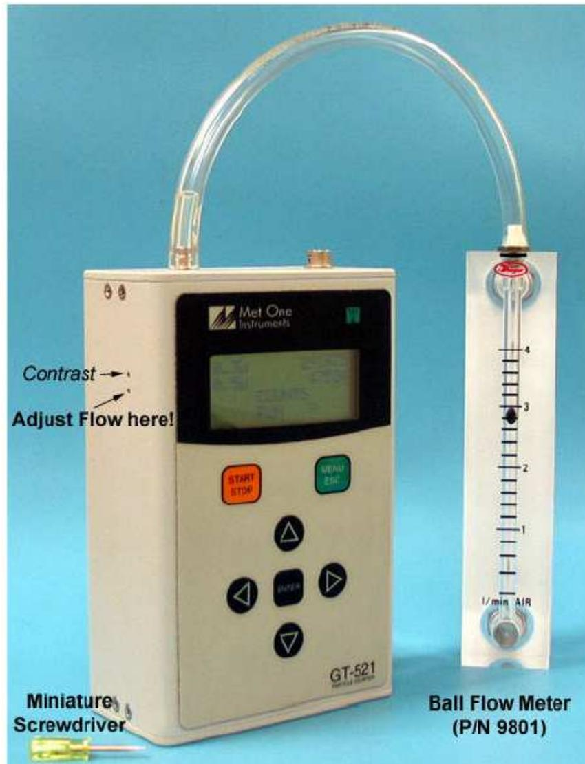
1. Verbinden Sie das Flowmeter mit dem Lufteinlass des GT-521. Am besten geeignet ist ein Tygon-Schlauchstück 1/8" Innendurchmesser
